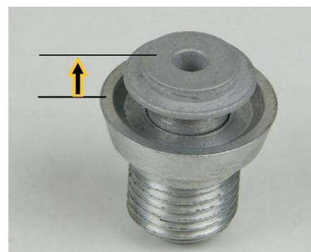
21. Setzen Sie die Hohlschraube in die rote Membran ein. Legen Sie das Doppelmembranplättchen auf (**Ober- und Unterseite beachten**) und verschrauben es mit der Vakuumzwischenplatte. Benetzen Sie hierzu die Gewinde der M3 Schrauben mit Schraubensicherungsmittel, damit ein gutes Vakuumverhalten gewährleistet ist.
