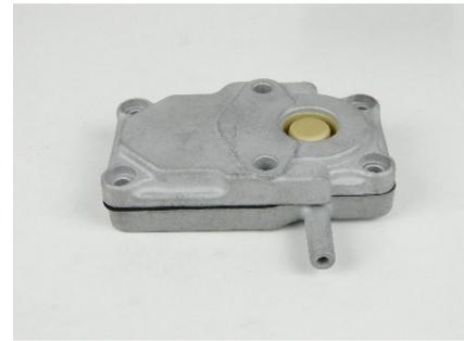
24. Setzen Sie nun langsam und vorsichtig beide Teile auf das obere Gehäuse auf. Drücken Sie dabei die Vakuumzwischenplatte und den unteren Gehäusedeckel zusammen, sodass die Vakuummembran nicht verrutscht. Verschrauben Sie die Gehäuseteile.
