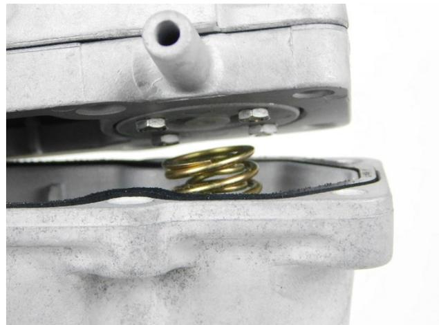
**Hinweis:** Achten Sie hierbei darauf, dass die innere Feder auf der Einstellschraube aufliegt und die äußere Feder in die Führung der Vakuumzwischenplatte eingreift. Desweiteren ist darauf zu achten, dass der Druckstift nicht aus der Hülse des Membranzylinders rutscht.
