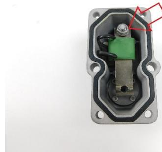
6. Lösen Sie die 4 M3 Schrauben der Druckkammer. Im Anschluss entnehmen Sie die Metallmembran und den darunterliegenden O-Ring.
