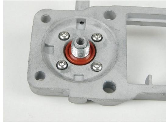
22. Schieben Sie jetzt den Distanzring, den 1. Membranteller (**Kante nach unten zeigend**), die schwarze Membran (**passt nur in einer Position**) und den 2. Membranteller (**Kante nach oben zeigend**) auf die Hohlschraube. Benetzen Sie das Gewinde mit Schraubensicherungsmittel und drehen Sie im Anschluss die Rändelmutter auf die Hohlschraube. Drücken Sie nun mit einem Finger von unten auf die Einstellschraube und ziehen die Rändelmutter mit einer Zange fest.
