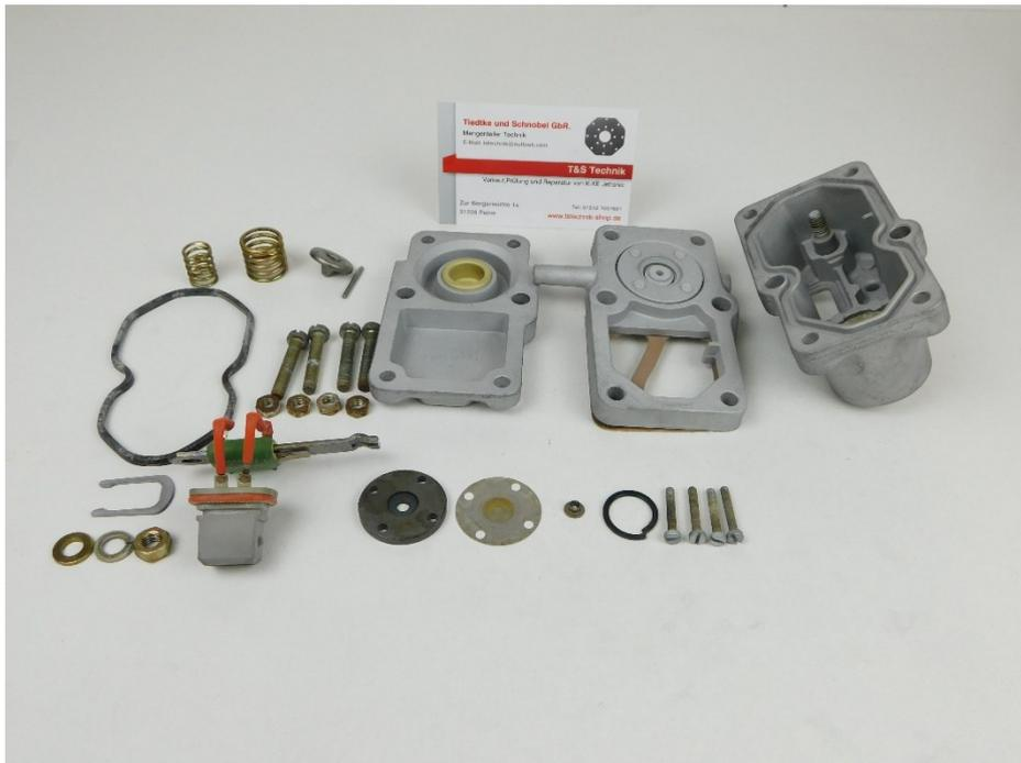
7. Prüfen Sie mit Hilfe einer Druckluftpistole den Durchfluss der beiden Anschlüsse des Warmlaufreglers.
