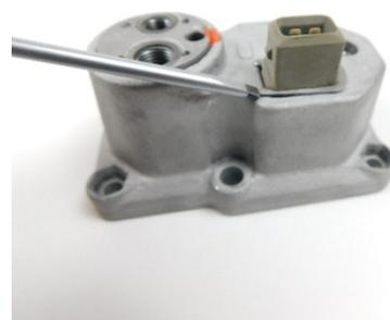
5. Lösen Sie die M6 Mutter vom Haltebolzen des Bimetallstreifens und entnehmen Sie die darunterliegende Unterlegscheibe und den Federring.
