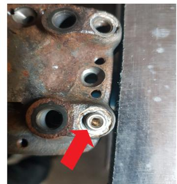
**2.9: Drehen Sie den Systemdruckregler an der Mengenteilerunterseite heraus. Achten Sie auf die Hülse die evtl im Gehäuse stecken bleibt.**
