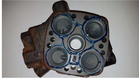
**3.6: Fügen Sie nun beide Mengenteilerhälften ohne Druck auszuüben wieder zusammen. Achten Sie dabei wieder auf das Loch zur Steuerdruckregulierung. Setzen Sie nun alle Schrauben ein, und ziehen Diese gleichmäßig über Kreuz in kurzen abständen an. Anzugsdrehmoment 10 Nm.**
