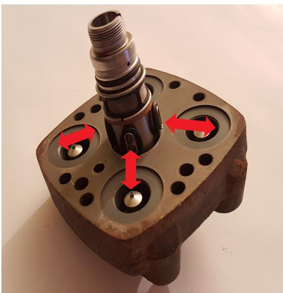
**3.3: Drehen Sie die 4 Einstellschrauben für die Federhülsen hinein. Spannen Sie die obere Hälfte des Mengenteilers in den Schraubstock so ein, dass Sie an die Einstellschrauben heran kommen. Setzen Sie die Federhülsen ein. Stellen Sie nun die Werte die Sie auf Ihrer Skizze notiert haben ein.**
